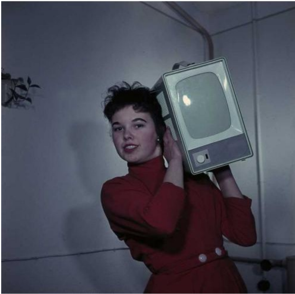
Volkes Flimmerkiste: Der Fernsehkoffer "Junior" wird 1959 vorgestellt. Der "Junior" hatte einen 18 mal 13 Zentimeter großen Bildschirm mit automatischer Kontrastregelung und Störunterdrückung. Das Gehäuse wog etwa 10 kg
